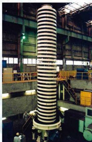
スパイラルエレベータ
